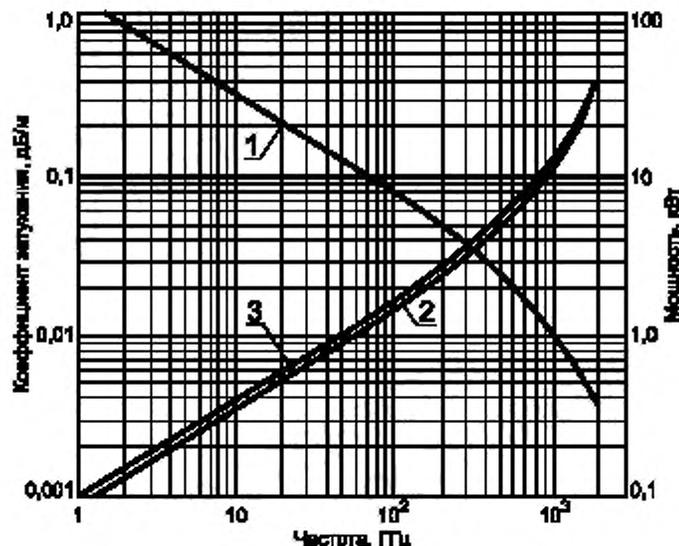
1 — допустимая мощность  $P$  на входе при температуре 40 °С и коэффициенте стоячей волны напряжения, равном 1; 2 — коэффициент затухания  $\alpha$  при температуре 20 °С; 3 — коэффициент затухания  $\alpha$  при температуре 40 °С и максимальной допустимой мощности
