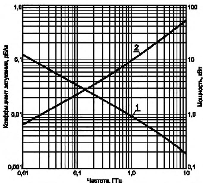
1 — допустимая мощность  $P$  на входе при температуре 40 °С и коэффициент стоячей волны напряжения, равном 1;
