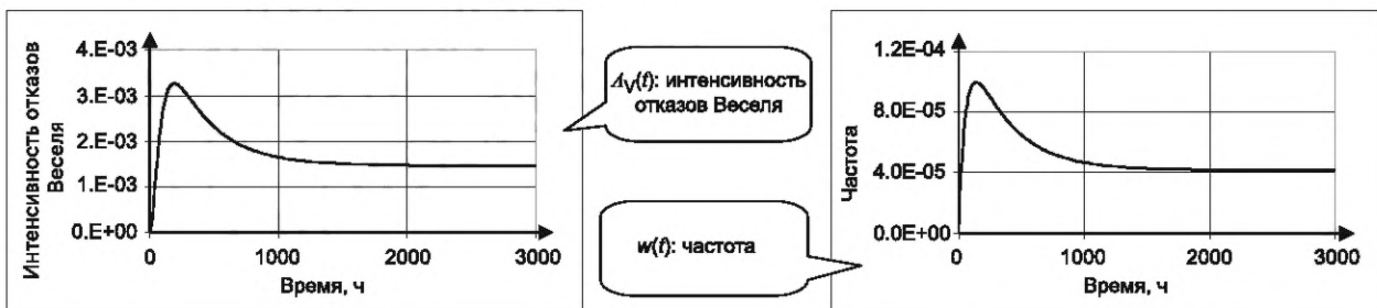
Рисунок F.11 — Интенсивность отказов и частота отказов, соответствующие рисунку F.10
