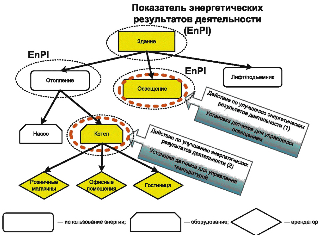
Рисунок 3 — Использование энергии в многофункциональном арендном здании
