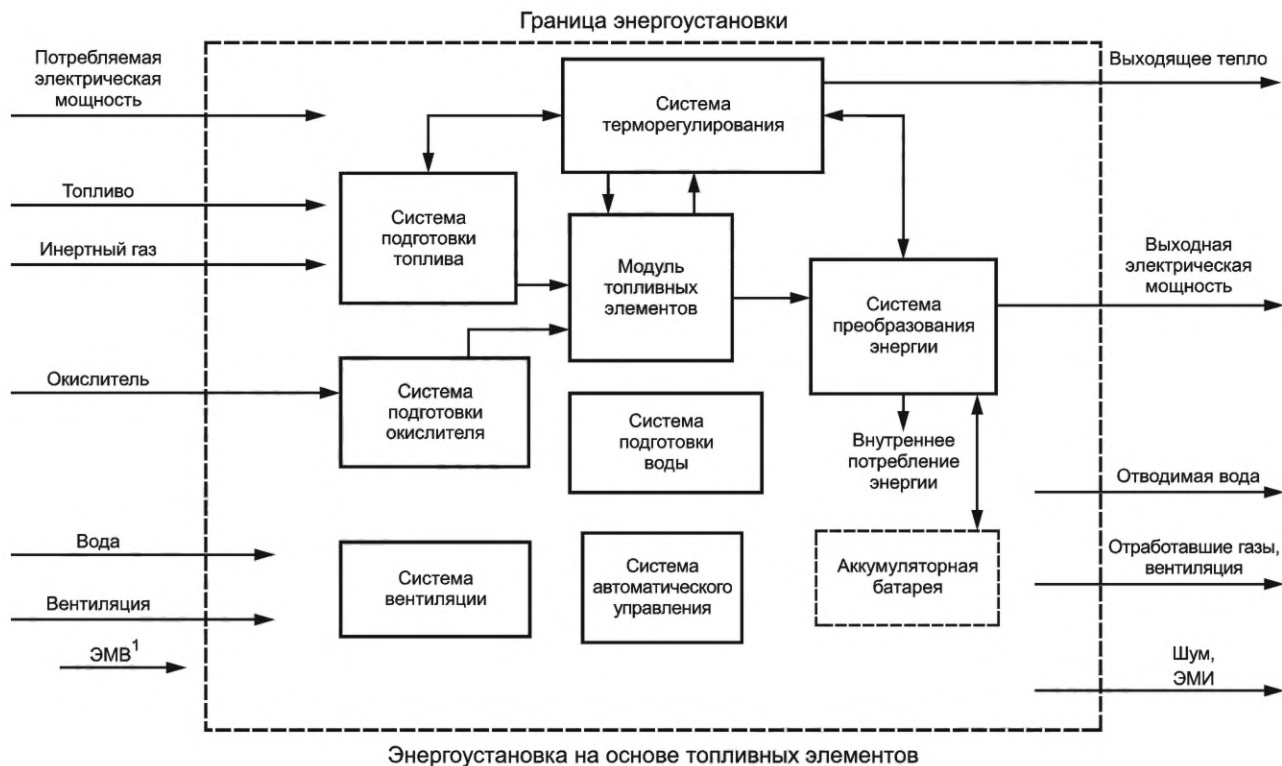
Рисунок 2 — Общая структура энергоустановки на основе топливных элементов
