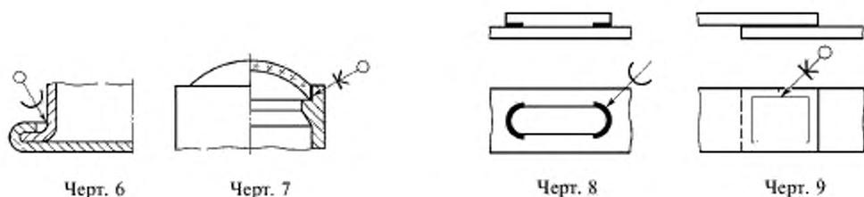
2.3. Швы, выполняемые по замкнутой линии, следует обозначать окружностью диаметром от 3 до 5 мм, выполняемой тонкой линией (черт. 6, 7, 9).
