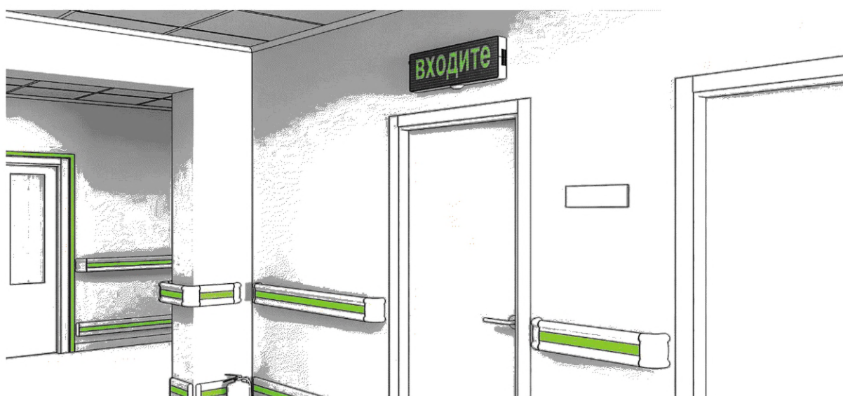
Рисунок А.2 — Пример размещения над дверью информационного (визуально-акустического) табло вызова пациентов, посетителей
