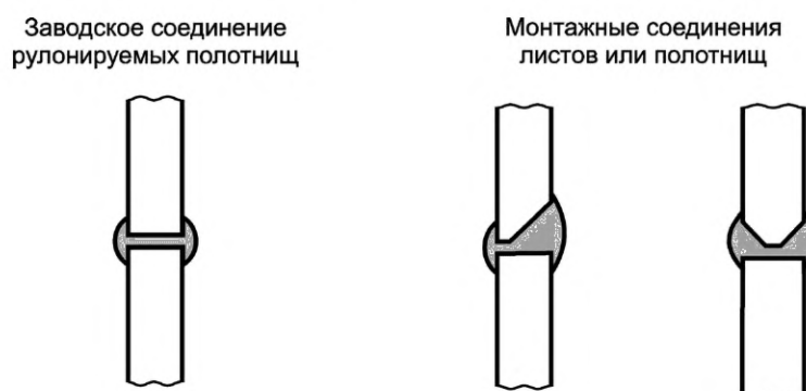
Рисунок 3 — Виды горизонтальных сварных соединений стенки
