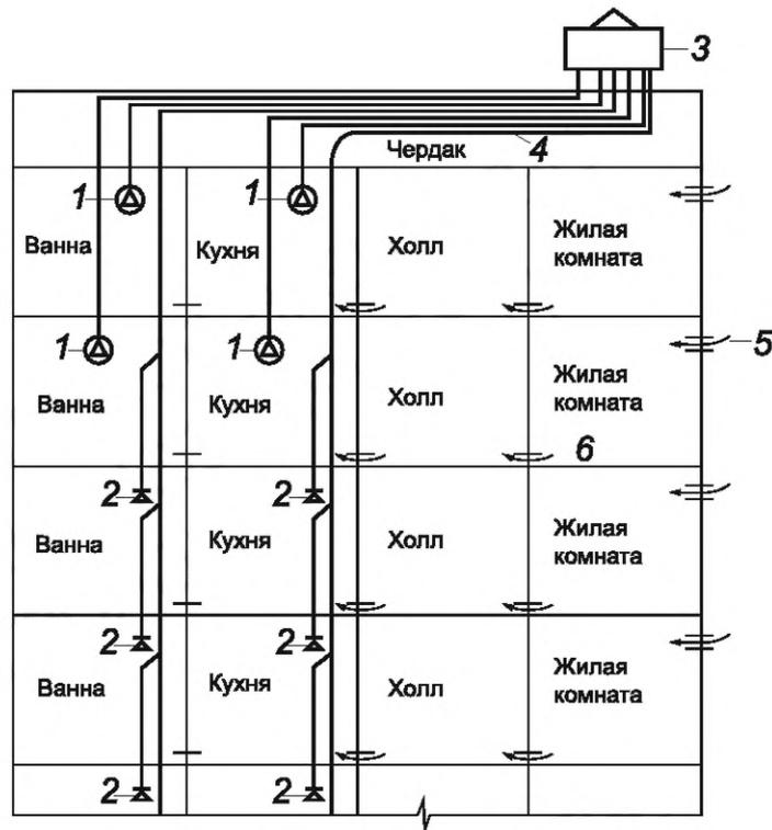
1 — индивидуальный вытяжной вентилятор; 2 — вытяжная решетка; 3 — вытяжная шахта с дефлектором; 4 — горизонтальный сборный воздуховод; 5 — приточный регулируемый клапан; 6 — переток
