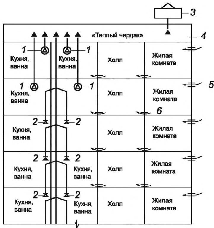
1 — индивидуальный вытяжной вентилятор; 2 — вытяжная решетка; 3 — вытяжная шахта с дефлектором;
