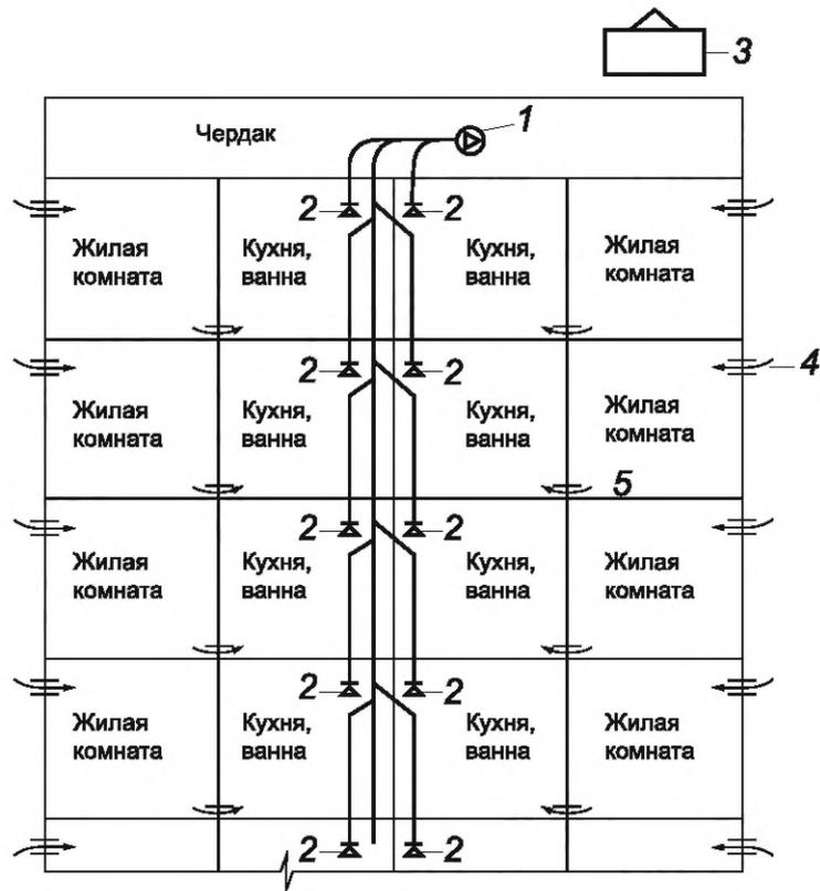
1 — центральный вытяжной вентилятор; 2 — вытяжной регулируемый клапан; 3 — дефлектор;
