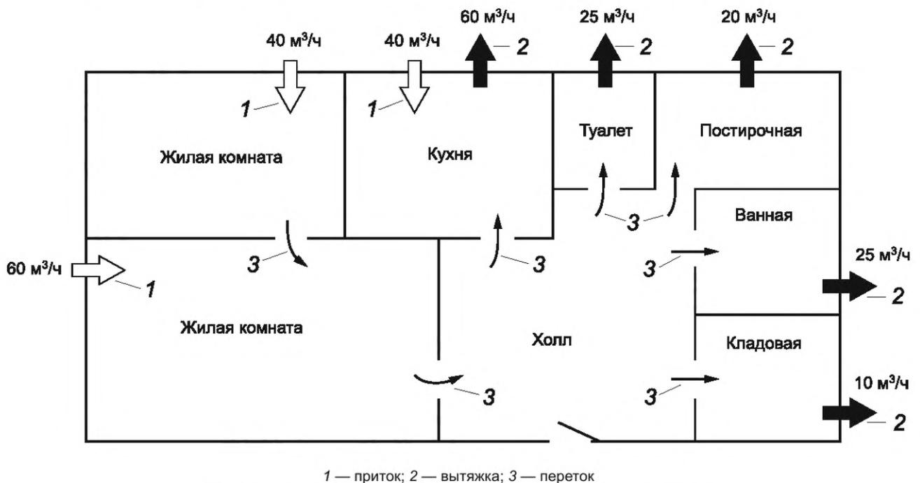
Рисунок 1 — Пример схемы организации воздухообмена в квартире
