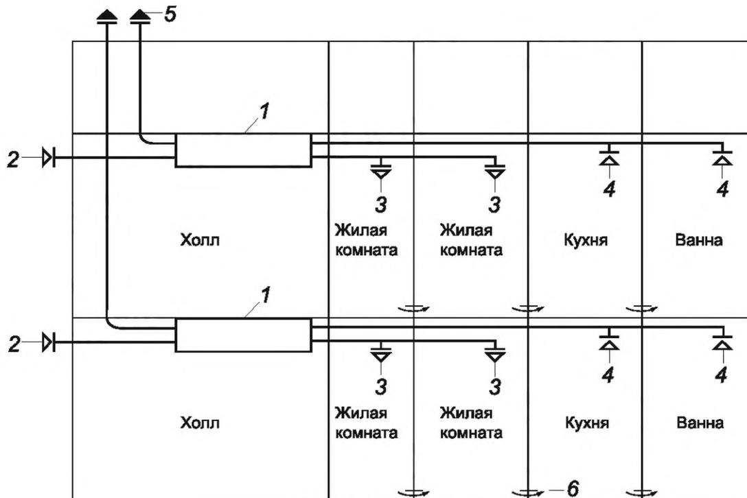
1 — автономная моноблочная приточно-вытяжная ВУ с теплоутилизатором; 2 — забор наружного воздуха; 3 — приточный регулируемый клапан; 4 — вытяжной регулируемый клапан; 5 — выброс удаляемого воздуха; 6 — переток
