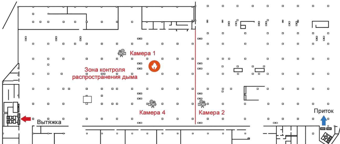
Рисунок Е.1 — Схема ИГД в дымовой зоне  $5000 \text{ м}^2$ , расположение стационарных видеокamер
