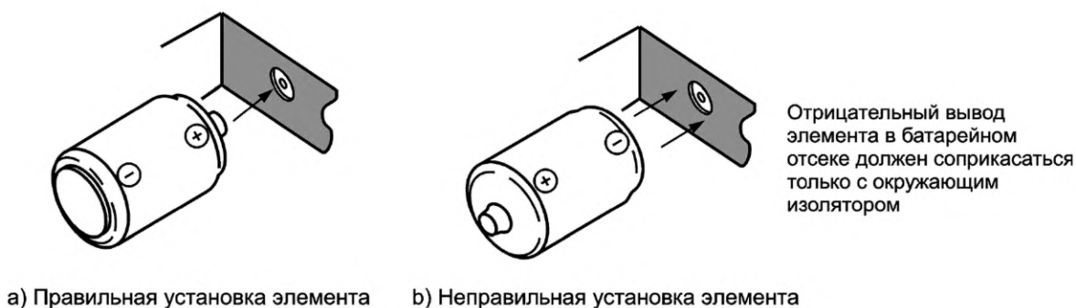
Рисунок В.3 — Положительный контакт в батарейном отсеке, утопленный внутри окружающего изолятора
