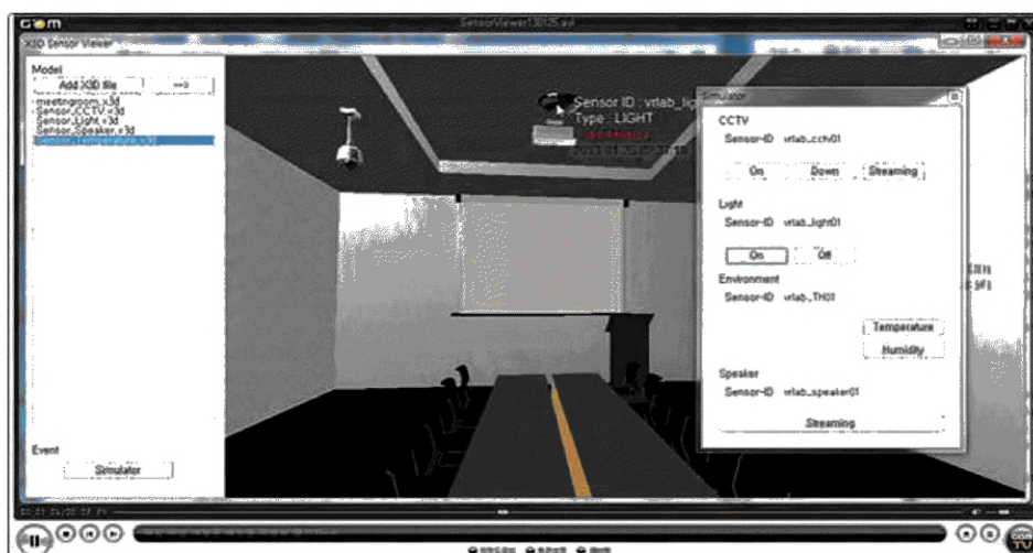
Рисунок Е.1 — Эмуляция сенсоров в помещении и их представление в 3D-сцене: сенсор освещенности
