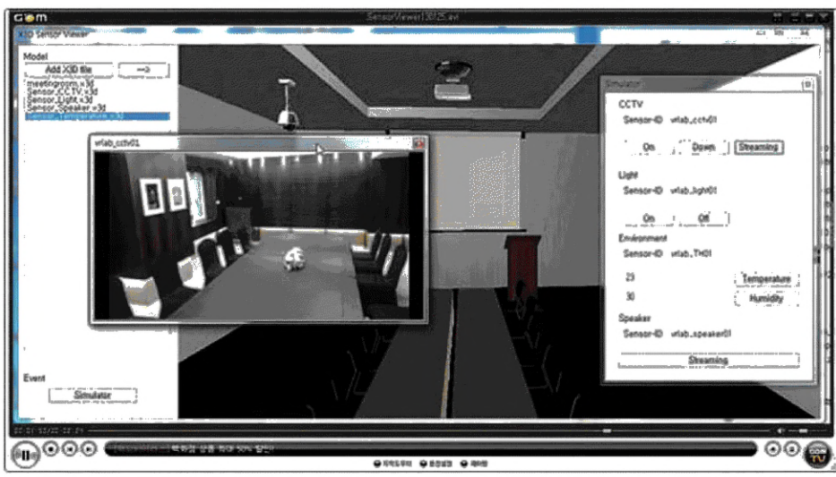
Рисунок Е.3 — Эмуляция сенсоров в помещении и их представление в 3D-сцене: сенсор камеры
