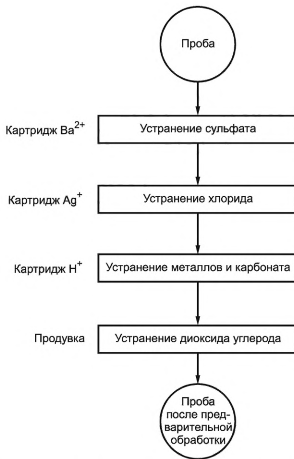
Рисунок С.1 — Этапы предварительной обработки проб
