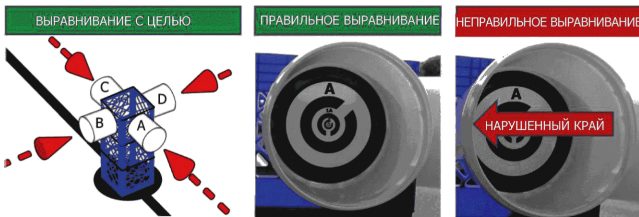
Рисунок 3 — Правильное и неправильное расположение робота на маршрутной линии
