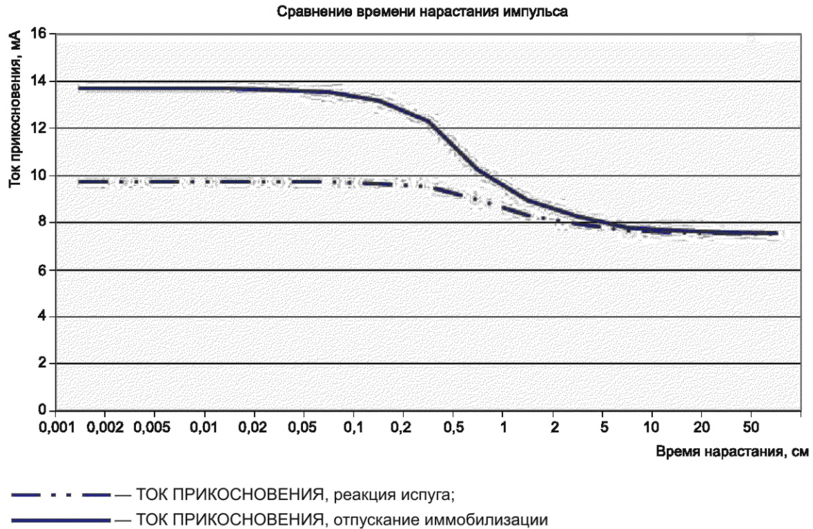
Рисунок Н.5 — График зависимости ТОКА ПРИКОСНОВЕНИЯ от времени нарастания для сигнала длительностью 20 мс прямоугольной формы
