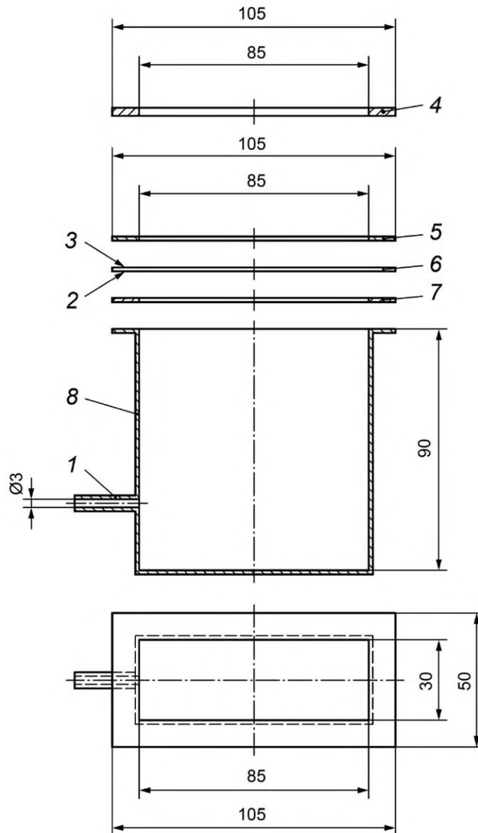
1 — штуцер для создания отрицательного давления и измерения перепада давления; 2 — внутренняя поверхность испытуемой пробы; 3 — внешняя поверхность испытуемой пробы; 4 — прямоугольный зажим (например, из нержавеющей стали); 5 — прямоугольная прокладка; 6 — испытуемая проба; 7 — прямоугольная прокладка; 8 — прямоугольная герметичная емкость (например, из нержавеющей стали)
