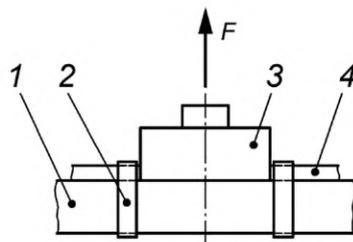
1 — опорная плита; 2 — ремни для фиксации; 3 — клапан выдоха; 4 — материал *изолирующего* костюма;  $F$  — усилие
