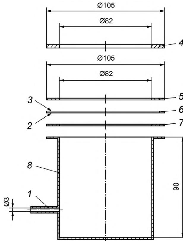
1 — штуцер для создания отрицательного давления и измерения перепада давления; 2 — внутренняя поверхность испытуемой пробы; 3 — внешняя поверхность испытуемой пробы; 4 — зажимное кольцо (например, из нержавеющей стали); 5 — уплотнительное кольцо; 6 — испытуемая проба; 7 — уплотнительное кольцо; 8 — цилиндрическая герметичная емкость (например, из нержавеющей стали)
