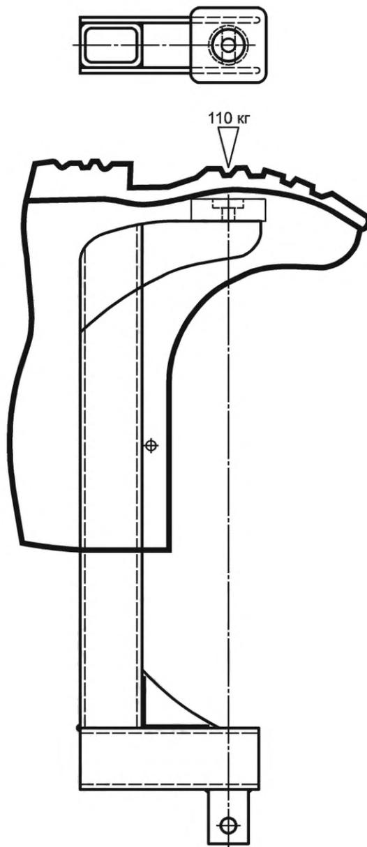
Рисунок 5 — Оборудование для испытания обуви с антипрокольными прокладками
