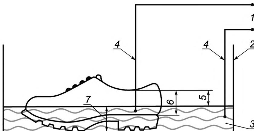
1 — подключение к источнику напряжения; 2 — резервуар; 3 — вода; 4 — электрод для подключения воды к двум полюсам источника напряжения; 5 — зазор от открытой части обуви или бахил до уровня воды; 6 — высота верха X; 7 — высота уровня воды
