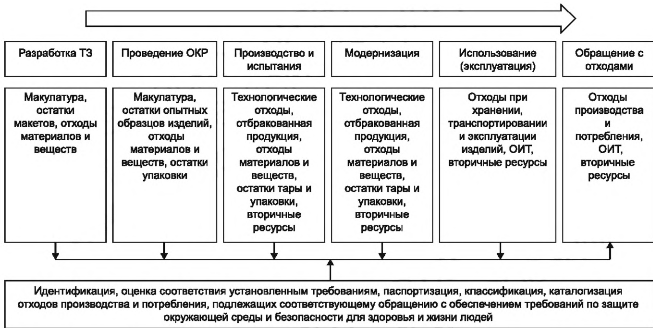
Рисунок А.1 — Схема образования на шести (из семи) стадиях жизненного цикла продукции (изделий) основных видов отходов
