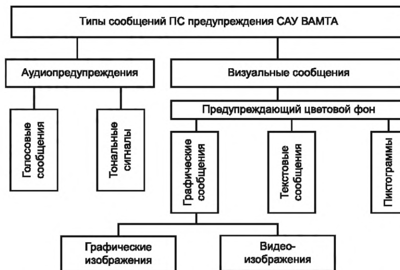
Рисунок 6 — Типы сообщений подсистемы предупреждения для оператора РВАМТА УА 2—5
