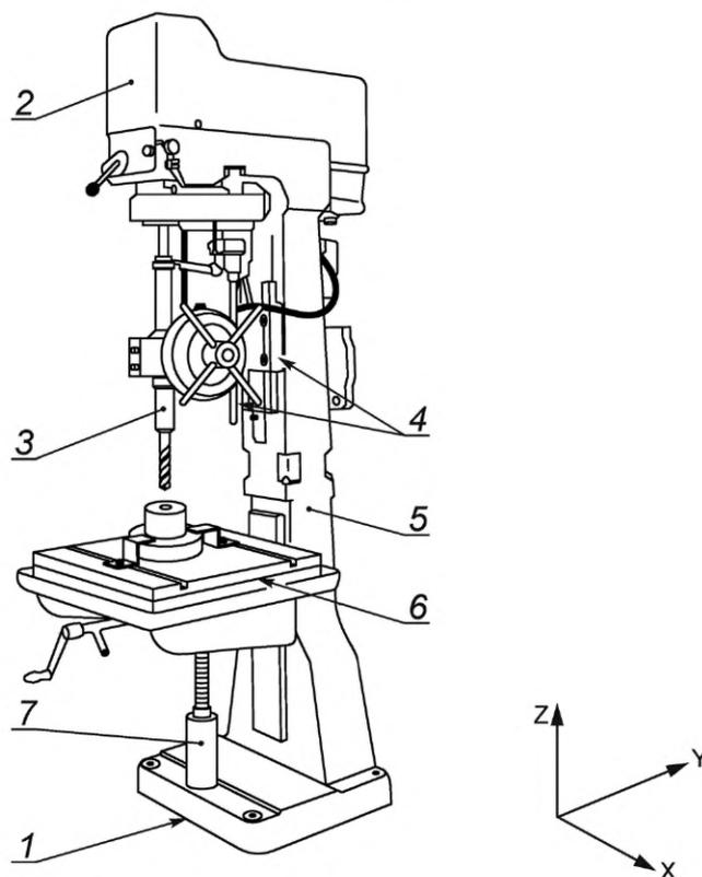
1 — фундаментная плита; 2 — шпиндельная головка (Z-ось); 3 — шпиндель; 4 — направляющие; 5 — колонна; 6 — стол (W-ось, дополнительная); 7 — механизм регулировки высоты стола
