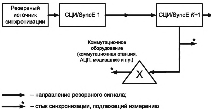
Рисунок 6 — Схема измерений параметров синхронизации по пункту 6 таблицы 1
