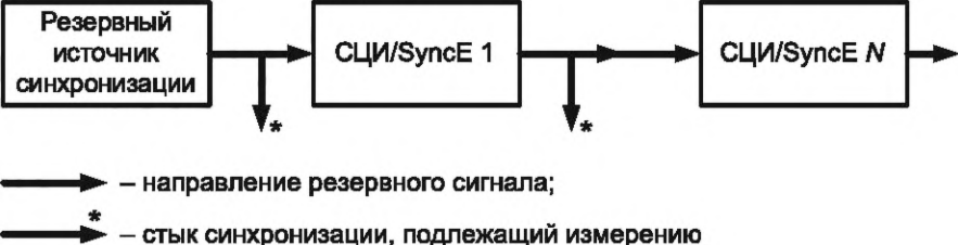
Рисунок 4 — Схема измерений параметров синхронизации по пункту 4 таблицы 1
