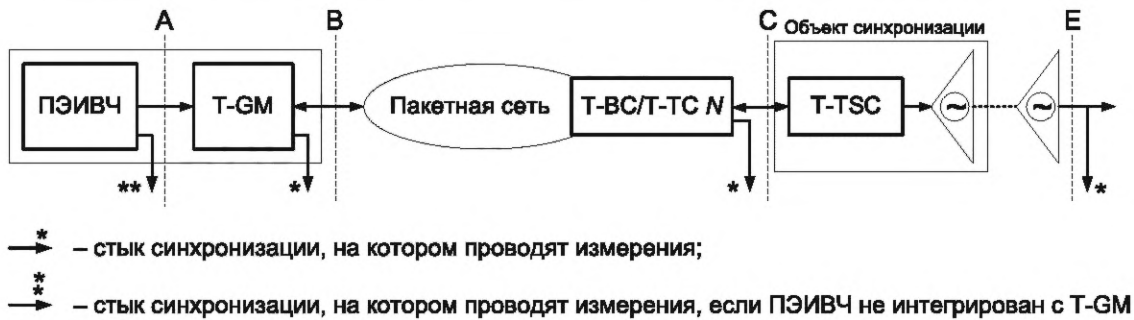
Рисунок 12 — Стыки синхронизации сети СШВ, подлежащие измерению, когда T-TSC встроен в объект синхронизации
