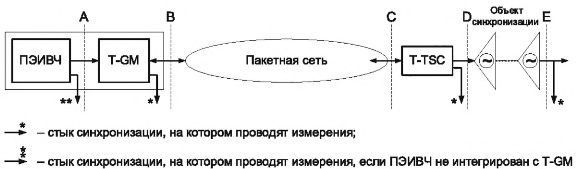
Рисунок 13 — Стыки синхронизации сети СШВ, подлежащие измерению, для случая, когда T-TSC является внешним для объекта синхронизации
