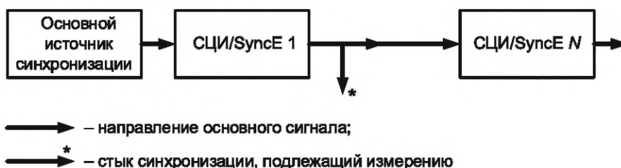
Рисунок 1 — Схема измерений параметров синхронизации по пункту 1 таблицы 1
