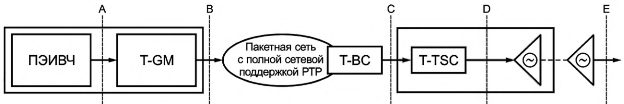
Рисунок В.1 — Стыки синхронизации сигналов шкалы времени, подлежащие измерению для случая, когда T-TSC встроен в объект синхронизации
