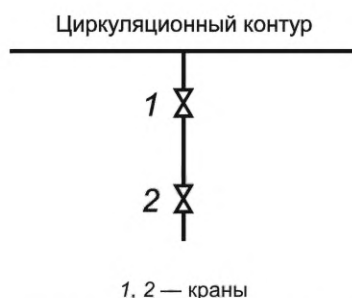
Рисунок 1 — Расположение арматуры в точке потребления для исключения загрязнения контура ВФП
