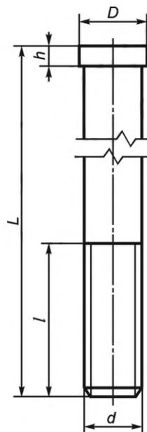
$D$  — диаметр головки болта, мм;  $d$  — диаметр резьбы, мм;  $L$  — длина болта, мм;  $h$  — высота головки болта, мм;
