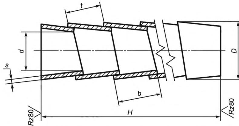
$D$  — диаметр головки болта, мм;  $d$  — диаметр резьбы, мм;  $H$  — длина ЗЭ, мм;  $s$  — ширина ЗЭ, мм;  $b$  — длина резьбы, мм;  $t$  — шаг, мм
