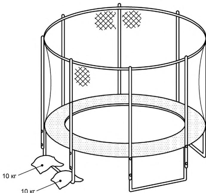
Рисунок 12 — Пример нагружения ножек
