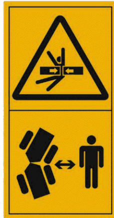
Рисунок С.3 — Раздавливание всего тела. Соблюдай безопасное расстояние от зоны складывания машины с шарнирно-сочлененной рамой
