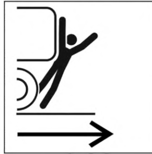
Рисунок D.21 — Пример символического изображения со стрелкой, обозначающей направление движения машины в целом
