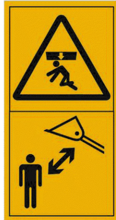
Рисунок С.30 — Раздавливание всего тела. Соблюдай безопасное расстояние от поднятой стрелы и ковша погрузчика
