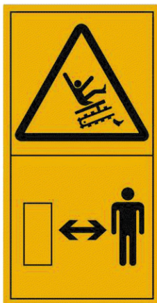
Рисунок С.27 — Затягивание или отрезание ноги или ступни. Соблюдение безопасного расстояния от источника опасности
