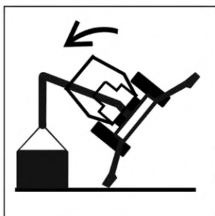
Рисунок А.41 — Опрокидывание машины. Перегруз. Экскаватор-погрузчик
