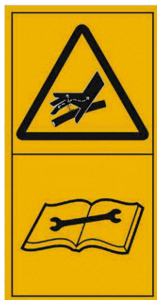
Рисунок С.17 — Жидкость под высоким давлением. Избегай утечки жидкости под высоким давлением. Читай техническое руководство для проведения технического обслуживания
