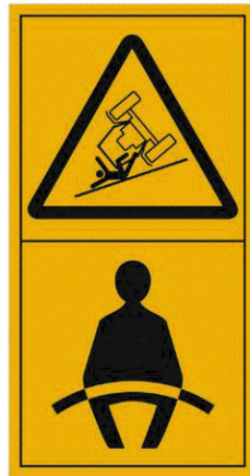
Рисунок С.31 — Опасность опрокидывания машины. Пристегни ремень безопасности
