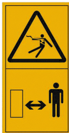
Рисунок С.14 — Электроудар или поражение электрическим током. Соблюдай безопасное расстояние от источника электроэнергии
