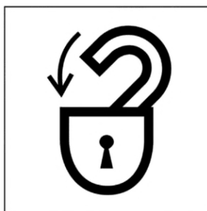
Рисунок В.11 — Перед входом в опасную зону установи замок безопасности
