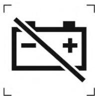
Рисунок 12 — Символ, изображающий устройство отключения аккумуляторной батареи (МЭК 7000-2063)
