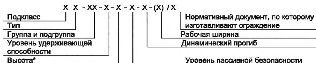
\* При установке ограждения на бордюре (парапете) дополнительно в скобках указывают общую высоту ограждения и высоту бордюра (парапета).
