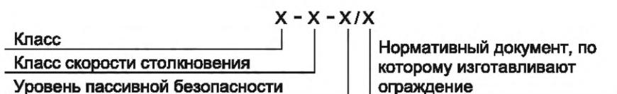
Рисунок А.4 — Последовательность расположения букв и цифр условного обозначения марки терминала
