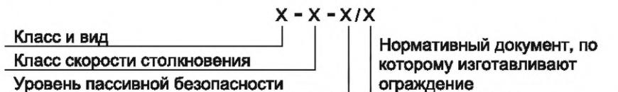
Рисунок А.5 — Последовательность расположения букв и цифр условного обозначения марки МФО
