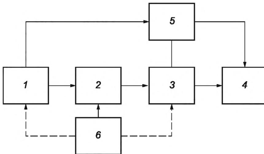
1 — исследуемый лазер; 2 — оптическая система; 3 — средство измерения параметра-критерия; 4 — средство измерения времени; 5 — устройство автоматическое; 6 — средства юстировки
