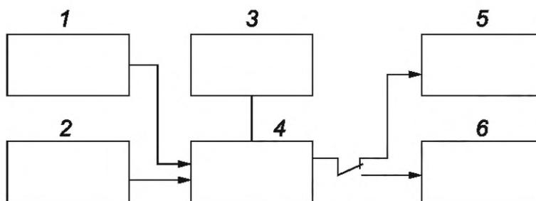
1 — осветитель и оптическая система фоновой засветки фотокатода; 2 — осветитель и оптическая система с устройством перемещения световой точки; 3 — генератор разверток; 4 — диссектор; 5 — осциллограф выделения строки; 6 — измеритель постоянного тока
