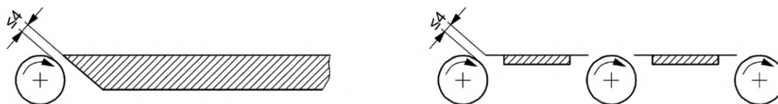
Рисунок 13 — Защита конвейера с подающими роликами
