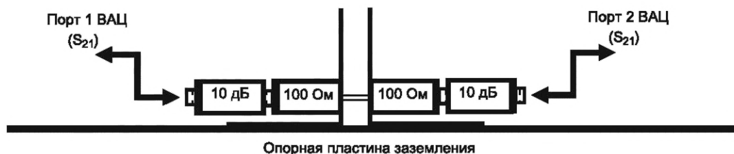
Рисунок А.9 — Нормирование схемы расположения оборудования для измерения коэффициента связи
