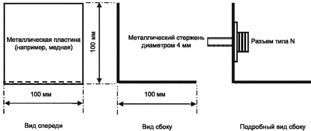
Рисунок А.3 — Размеры опорной пластины
