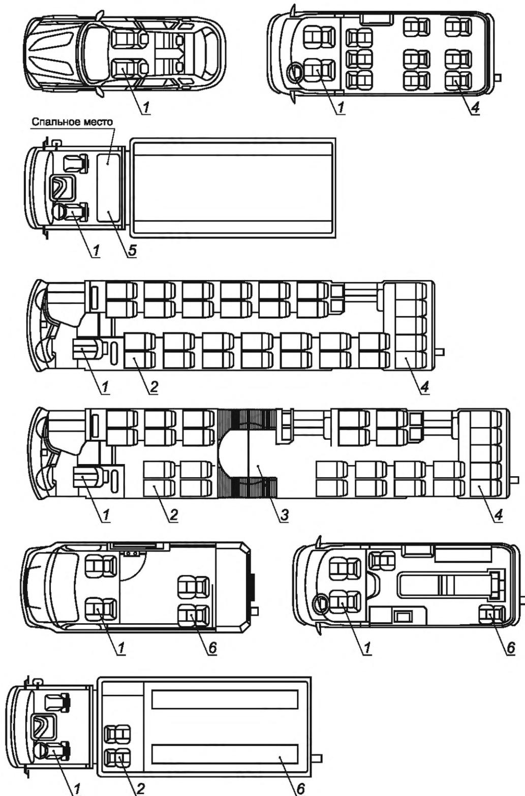
1 — зона дыхания водителя; 2 — зона дыхания сидящего пассажира, находящегося в передней части салона ТС; 3 — зона дыхания стоящего пассажира в зоне сочленения ТС категории М<sub>3</sub>; 4 — зона дыхания сидящего пассажира, находящегося в задней части салона ТС; 5 — зона дыхания спящего человека на спальном месте; 6 — зона дыхания сидящего пассажира, находящегося в задней части пассажирского помещения специального или специализированного ТС
