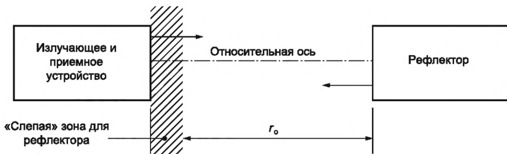
б) Тип R, приемо-излучающее устройство и рефлектор. Ретрорефлекторный фотоэлектрический сенсорный выключатель
