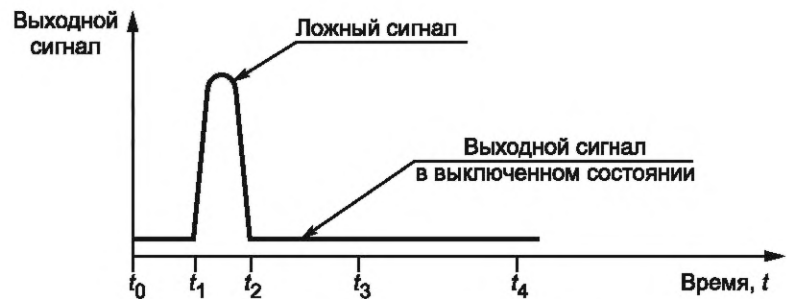
б) Коммутационный элемент в выключенном состоянии
