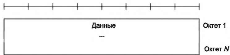
Рисунок 21 — RLC PDU для объекта TM RLC
