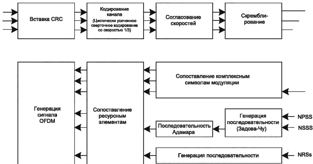
Рисунок 13 — Обработка физического downlink-канала
