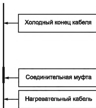
Рисунок 1 — Типовое расположение компонентов при испытании соединительной муфты
