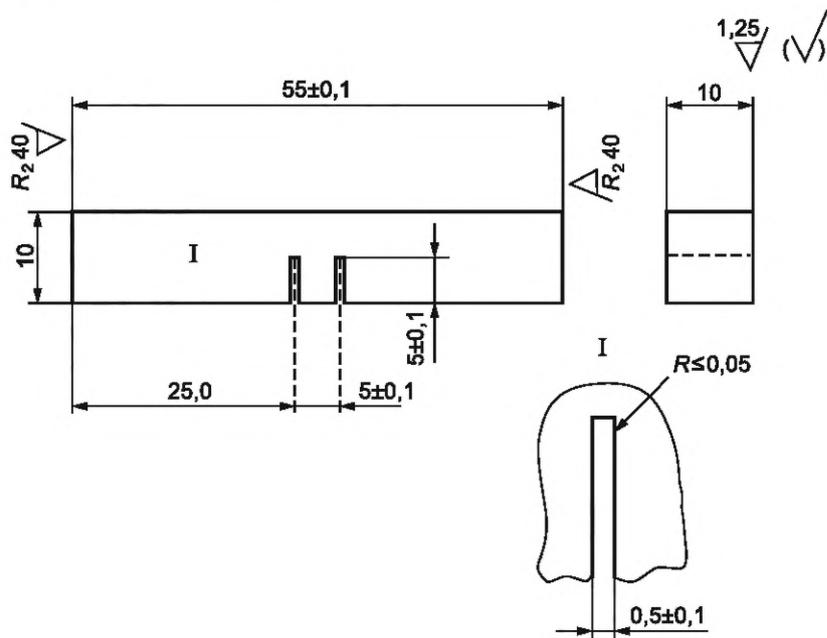
Рисунок 1 — Ударный образец с двумя надрезами
