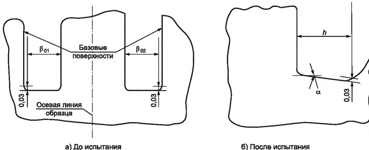
$\beta_{01}, \beta_{02}$  — ширина неразрушенного надреза, выбираемая в зависимости от базового торца, мм
