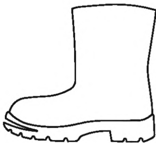
Рисунок А.3 — Расслоение подошвы
