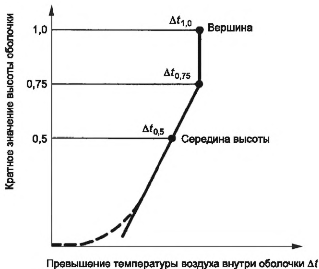
Рисунок 9 — Кривая, характеризующая превышение температуры для НКУ с площадью поверхности с эффективным рассеиванием тепла A_e не более 1,25 \text{ м}^2
