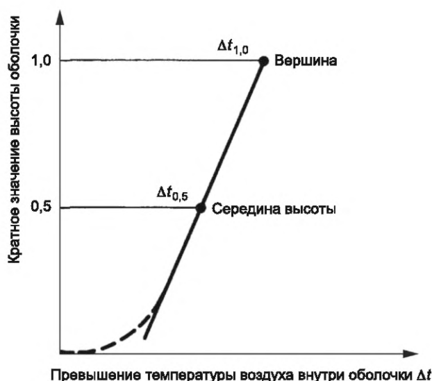
Рисунок 8 — Кривая, характеризующая превышение температуры для НКУ с площадью поверхности с эффективным рассеиванием тепла A_e более 1,25 м 2
