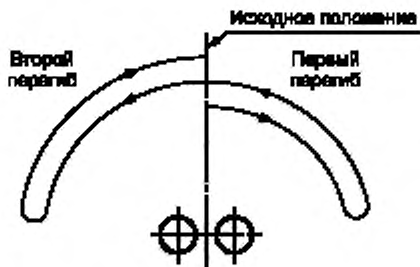
Рисунок 1 — Схема испытания на перегиб
