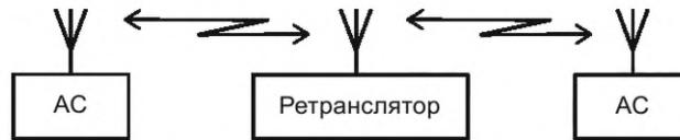
Рисунок 4 — Структурная схема организации ППР с использованием ретранслятора сигналов
