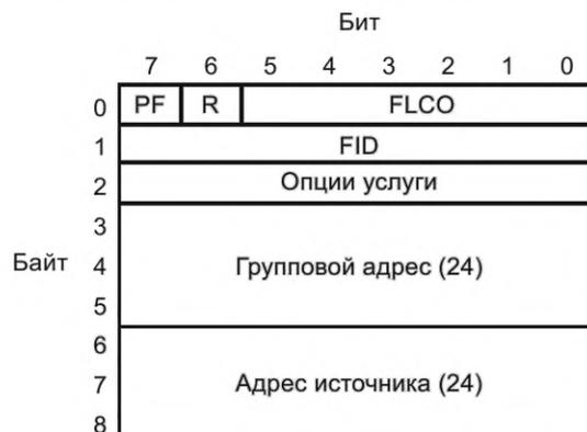
Рисунок 59 — Структура заголовка Full LC для группового вызова
