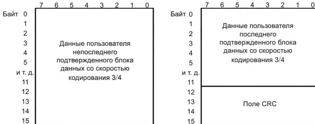
Рисунок Б.12 — Порядок размещения пользовательских данных и поля CRC для пакетов «Продолжение данных FEC со скоростью кодирования  $\frac{3}{4}$ » и «Последний блок данных FEC со скоростью кодирования  $\frac{3}{4}$ »
