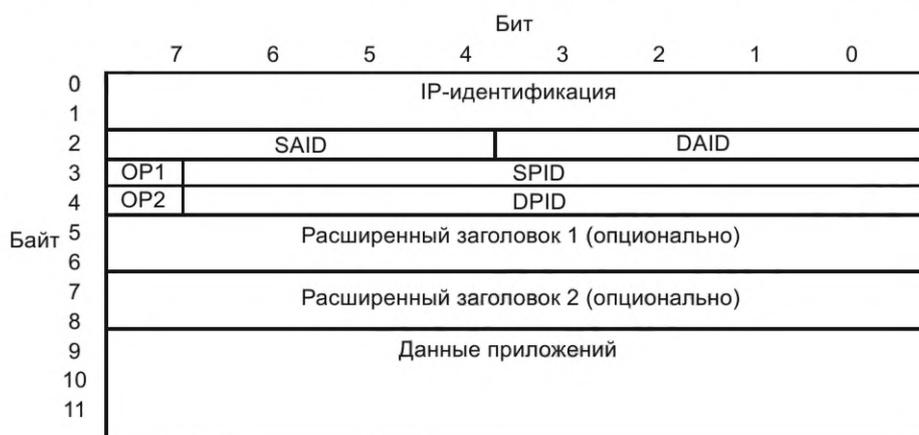
Рисунок 52 — Структура первого блока неподтверждаемых данных с FEC, со скоростью кодирования  $\frac{1}{2}$  и со сжатием заголовка UDP/IPv4
