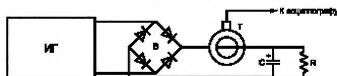
В — выпрямительный мост; Т — токоусъемник с выходом на осциллограф;
