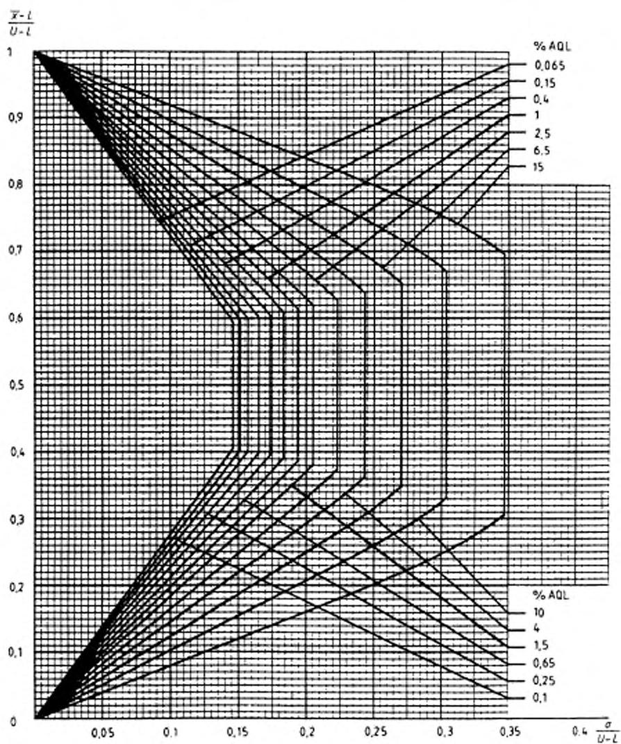
Диаграмма  $\sigma$ -М — Кривые приемки для предельных значений с общим уровнем качества:  $\sigma$ -метод для кода объема выборки М
