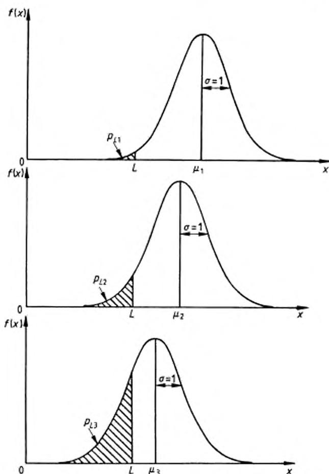
Рисунок 7 — Доля несоответствующих единиц продукции для постоянного  $\sigma = 1$  и различных значений среднего ( $\mu_1$ ,  $\mu_2$ ,  $\mu_3$ ) по отношению к заданному нижнему пределу поля допуска характеристики качества
