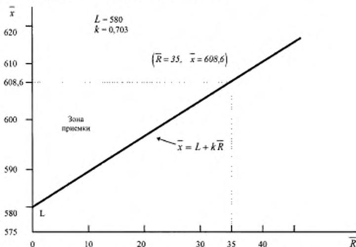
Рисунок 16 — Графический метод для одностороннего допуска и предельных значений с общим уровнем качества
