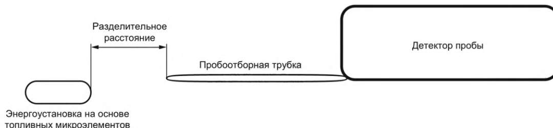
Рисунок 5 — Схема измерения предельной концентрации выбросов газа для рабочих устройств
