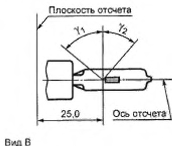
Рисунок 3 — Зона без оптического искажения 35
