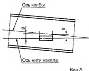
Рисунок 6 — Эксцентриситет оси колбы 38
