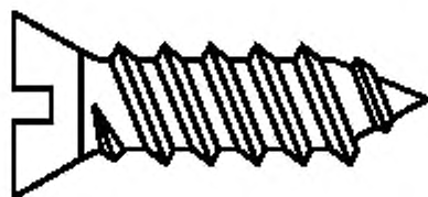
Рисунок 1 — Самонарезающий формирующий винт (3.6.10)
