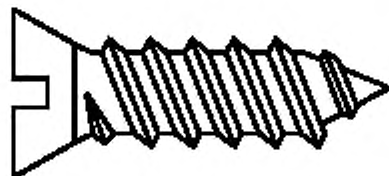
Рисунок 1 — Самонарезающий формующий винт
