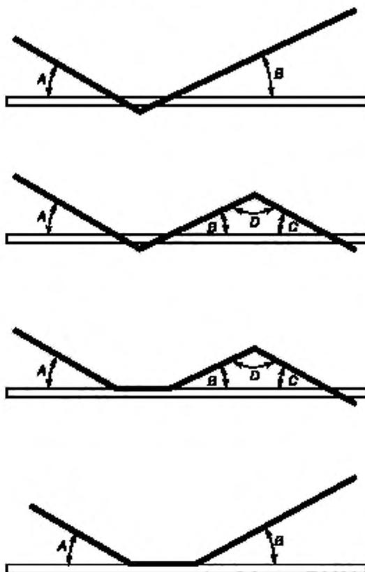
$A$  — угол между туловищем пациента и горизонталью;  $B$  — угол между поднятой ногой и горизонталью;  $C$  — угол между опущенной ногой и горизонталью;  $D$  — угол между поднятой и опущенными частями ноги
