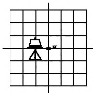
Рисунок 108 — Обозначение ПРЕДЕЛЬНОЙ РАБОЧЕЙ НАГРУЗКИ
