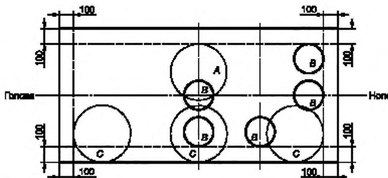
A — подушка с нагрузкой (ИЗНОСОСТОЙКОСТЬ); B — ударный копер; C — подушка с нагрузкой (ПРОГИБ КРОВАТИ)
