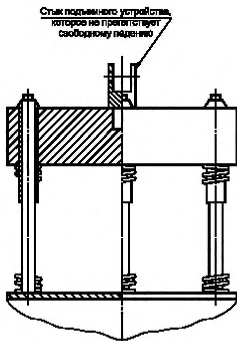
Тело ударного копра имеет приблизительно 200 мм в диаметре и отделено от ударной поверхности посредством винтовых компрессионных пружин. Тело свободно падает под углом  $90^\circ$  к центральной площадке ударной поверхности. Общая масса устройства —  $(25 \pm 0,1)$  кг, а масса тела копра и соответствующих частей (минус пружины) —  $(17 \pm 0,1)$  кг.
