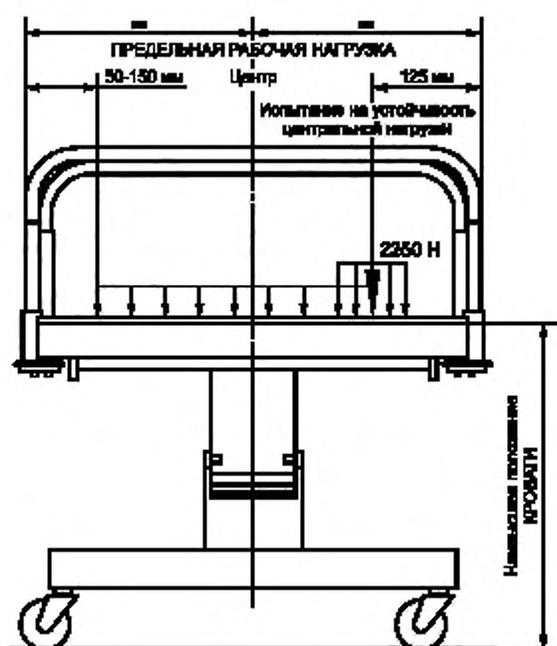
Рисунок 105 — Испытание на поперечную устойчивость:
