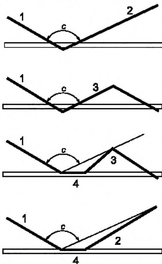
1 – спиная секция; 2 – ножная секция; 3 – промежуточная секция; 4 – тазобедренная секция
