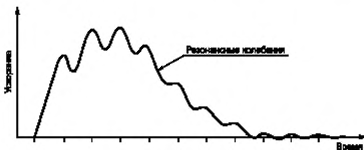
Рисунок 4 — Отклик акселерометра на удар
