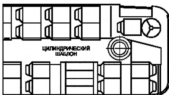
Рисунок 3.14 (см. 5.7.5.3.3) — Сиденья установлены против направления движения
